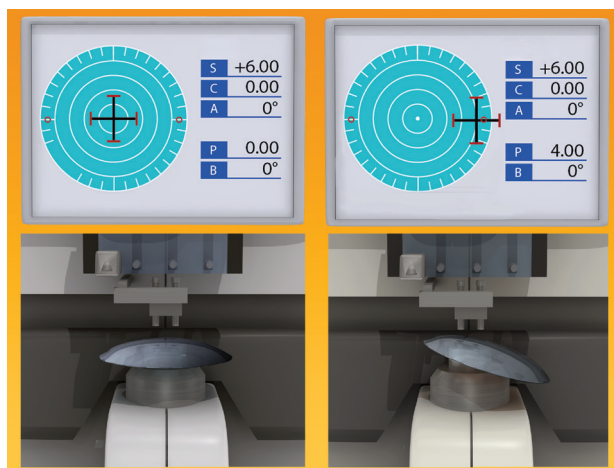
Figure 57 : Montage d'une paire de lunettes prismatiques (prisme de 4Δ)
